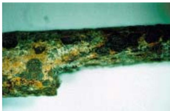
**Figura A.14** *CBT en un cable pretensado*
